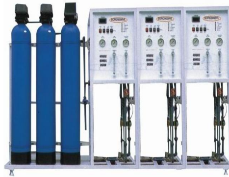
填料再生装置
